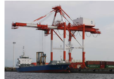
ガントリークレーンで荷をおろす様子
