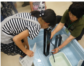
透視度計による濁り調査
