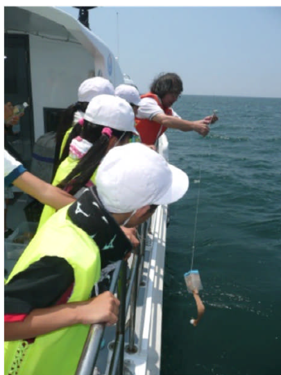
ペットボトルを使った手作りの採水器
