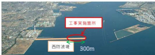
しかし、完成から約45年が経過しており、老朽化と大規模地震発生時の沈下及び来襲する津波に対する防護効果の低下が懸念されるため、第一線防波堤として地震・津波対策(粘り強い構造への改良)の推進を目的に、平成26年度から防波堤の改良を行っています。平成26年度前半では被覆石の投入と均しを行い、年度後半では被覆ブロックの製作工事を行っています。
