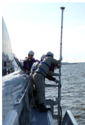
送受波機の設置
